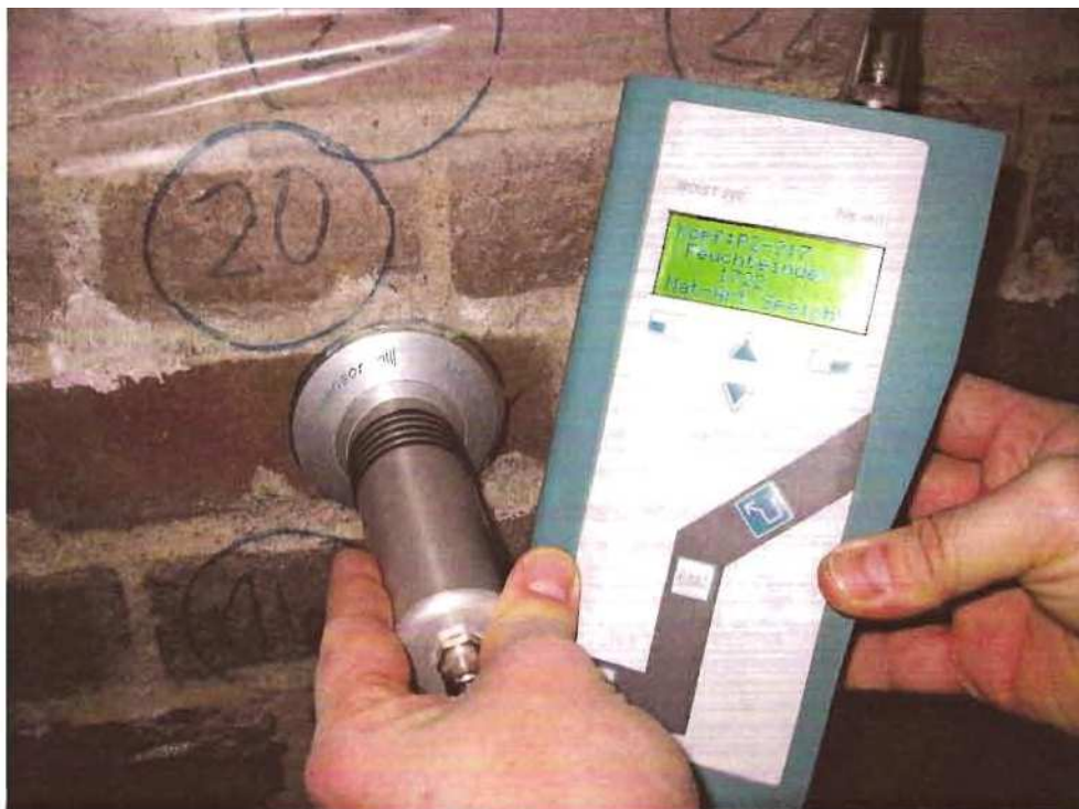
Fot. 6: Pomiar wilgotności za pomocą miernika mikrofalowego.
