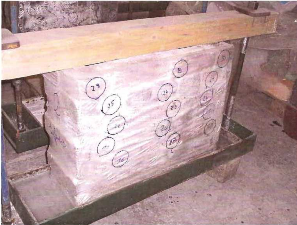
Fot. 1: Próbkę muru podczas kondycjonowania dla ustalenia stopnia zawilgocenia.
