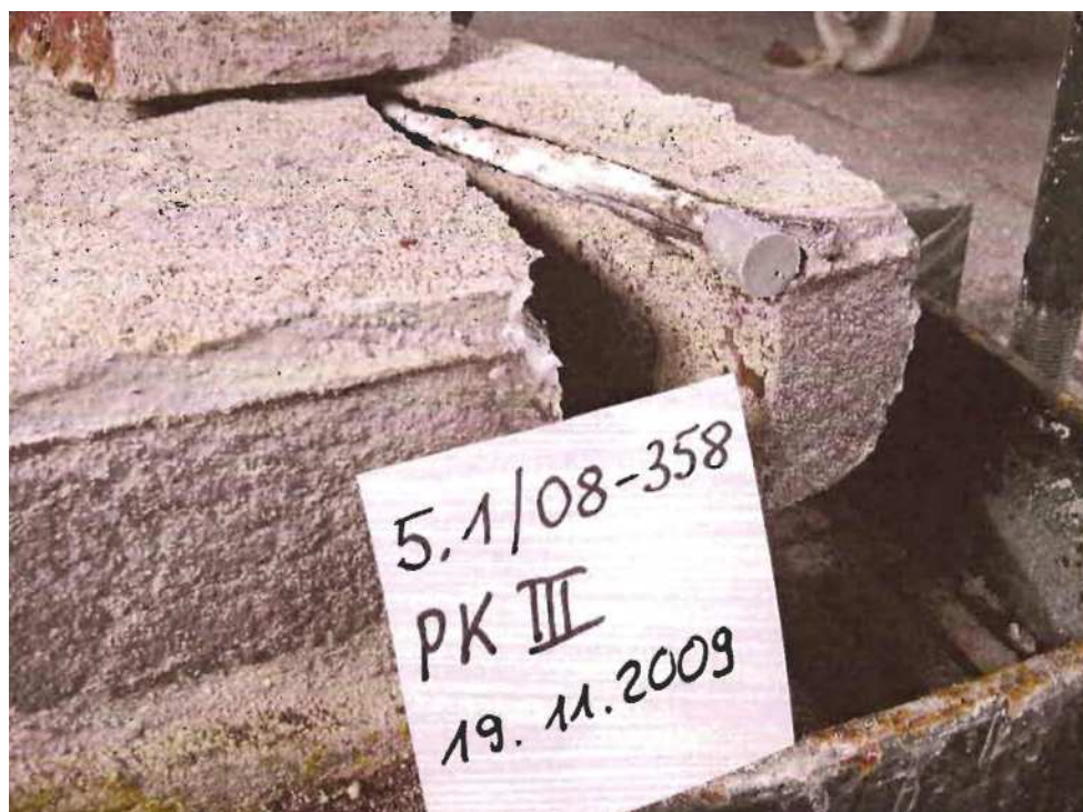
Fot. 8: Szczegół otworu iniekcyjnego po badaniu.
