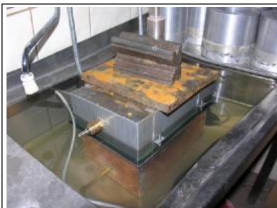
Sprawdzanie szczelności komory RnBOX
